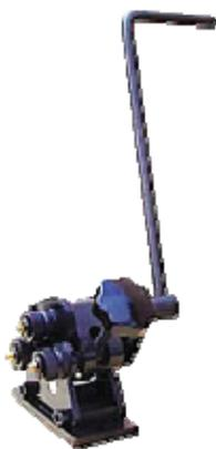
Станок ручной настольный используется для гибки металлических прутков и полос. Профилегиб применяют для цехов и мастерских с небольшой производительностью.
